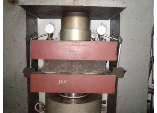
Thí nghiệm nén ngắn hạn và dài hạn gối cầu cao su cốt bản thép
