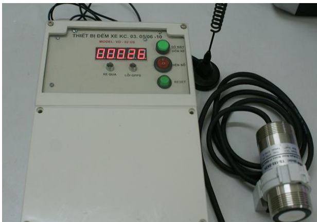
Thiết bị đếm xe sử dụng đầu đo siêu âm
