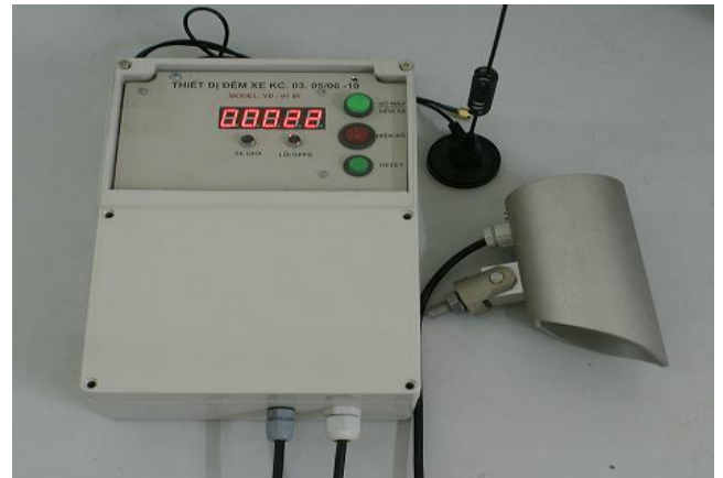
Thiết bị đếm xe sử dụng đầu đo hồng ngoại
